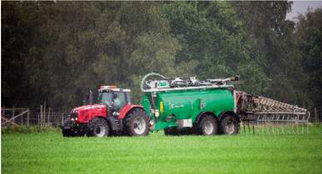
Risken för skadlig markpackning ökar vid körning med stora maskiner, t.ex. vid flytgödselspridning.
