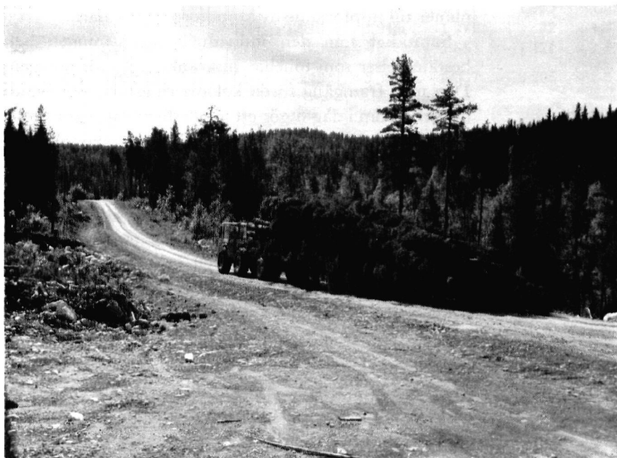
En modern skogshjultraktor transporterar hela träd på en skogsväg i Norrland. Metoden innebär lagarbete och stor insats av maskiner; trädet kan ha fällts av en högmekaniserad skogsavverkningsmaskin och är alltså okvistat och obarkat.
