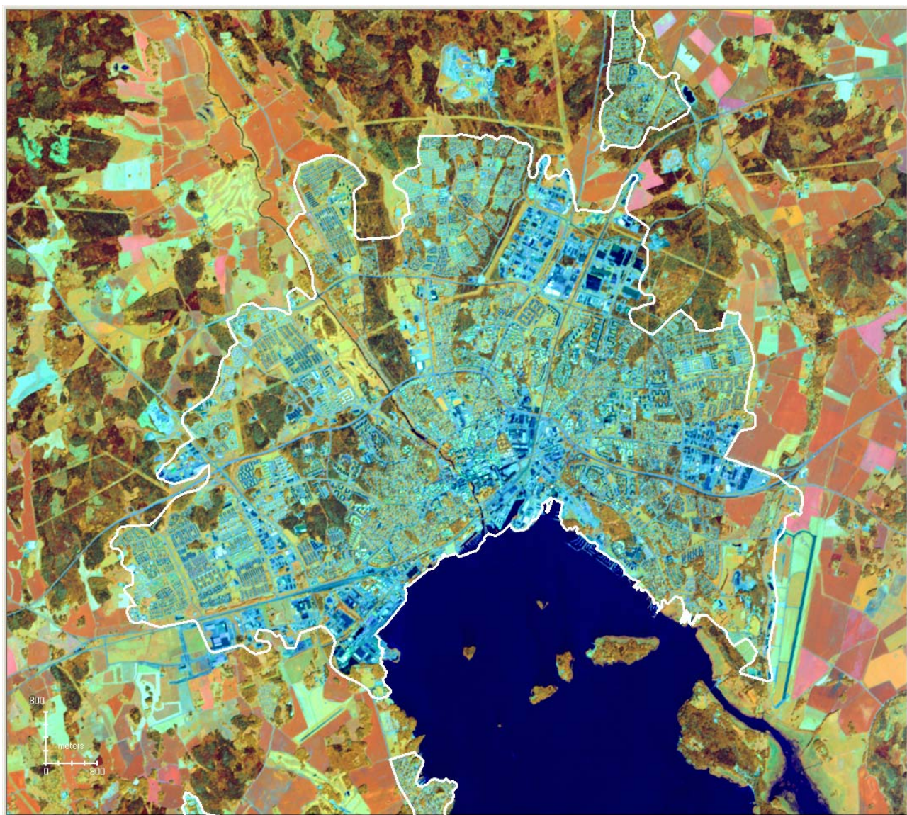
Figur 3. Västerås från SPOT-5 från 10 juli 2005. RGB = band 3,4,2. SCB:s tätortsgräns från 2005 i vitt. Skala ca 1:85 000. Gulbruna ytor är grön vegetation, blå ytor är hårdgjorda ytor eller bar jord samt mörkbruna ytor är barrskog. Orangea till röda ytor är jordbruksmark.
