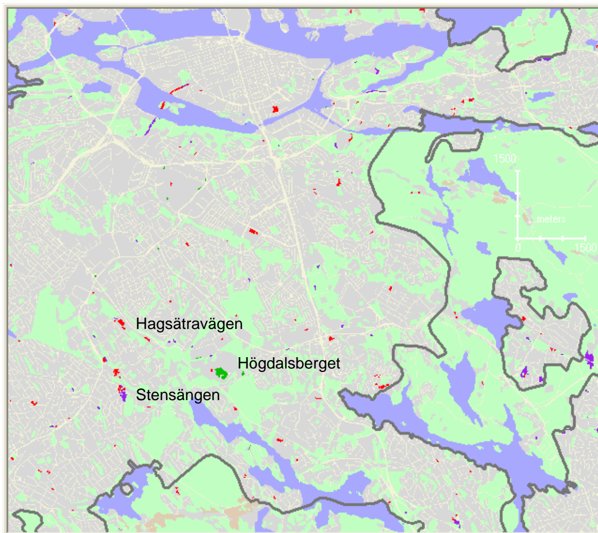
Figur 17. Stockholm. Förändringar mellan 4 september 1999 och 29 juni 2006. Förändringar inom skogsmarken i form av grönyta som blivit exploaterad yta är lila. De förändringar inom övrig mark som övergått från "grönyta" till hårdjord yta är röd och de ytor som ändrats från hårdjord yta till "grönyta" är mörkgröna. Skogsmarken är ljusgrön, jordbruksmarken ljusbrun, vatten blå och urban mark grå. SCB:s tätortsgräns från 2005 i grått. Skala 1:85 000.
